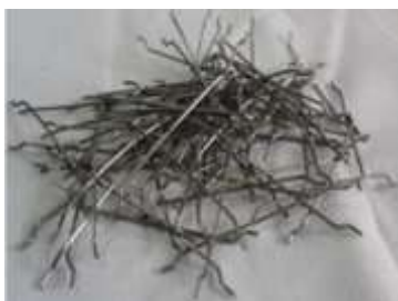
شکل (۱): الیاف فولادی مورد استفاده برای ساخت نمونه‌ها
