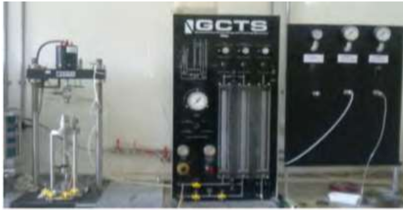
شکل ۱۰: دستگاه سه محوره سیکلی مورد استفاده در آزمایش
