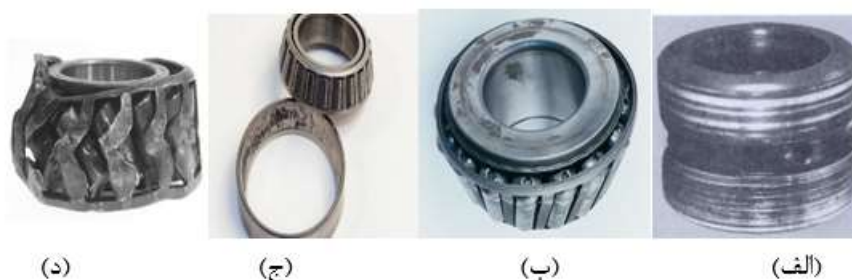
شکل ۲: انواع عیوب در یاتاقانها، الف) سایش، ب) عیب ناشی از برخورد صفحات، ج) خوردگی، د) عیب ناشی از ذرات خارجی
