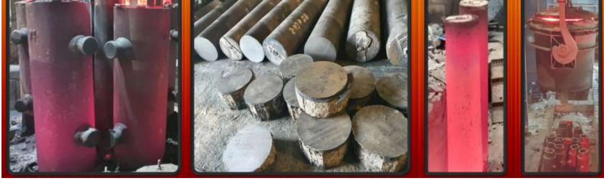
شکل ۸: خط ریخته گری شمش آلیاژی تک باری
