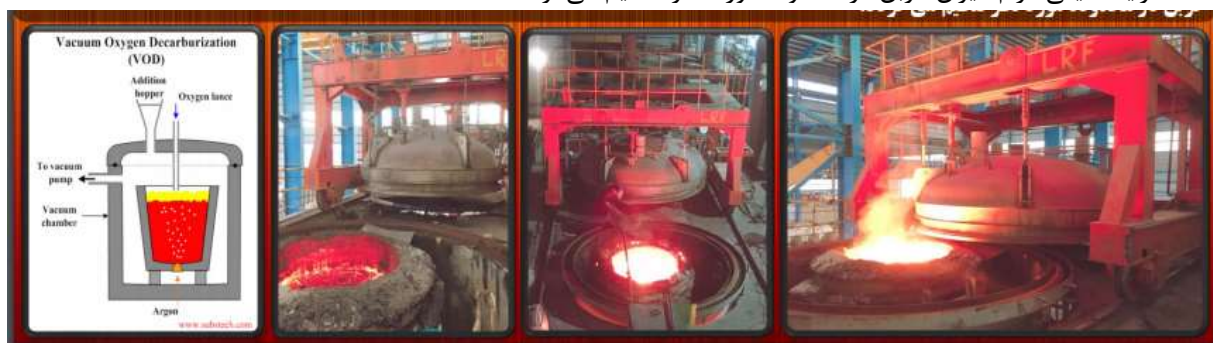
شکل ۷: سیستم کربن زدایی فولادهای آلیاژی تحت خلا
