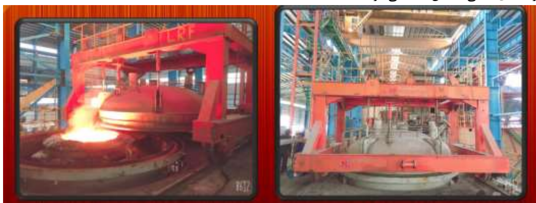
شکل ۶: سیستم گاززدایی فولادهای آلیاژی تحت خلا
