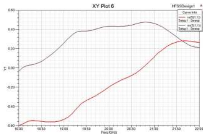
شکل ۱۱: نمودار بخش حقیقی و بخش موهومی امپدانس ورودی برای آنتن ارائه fereg2-12ghz (a), fereg 12-18ghz(b), fereg 18-22ghz(c) .
