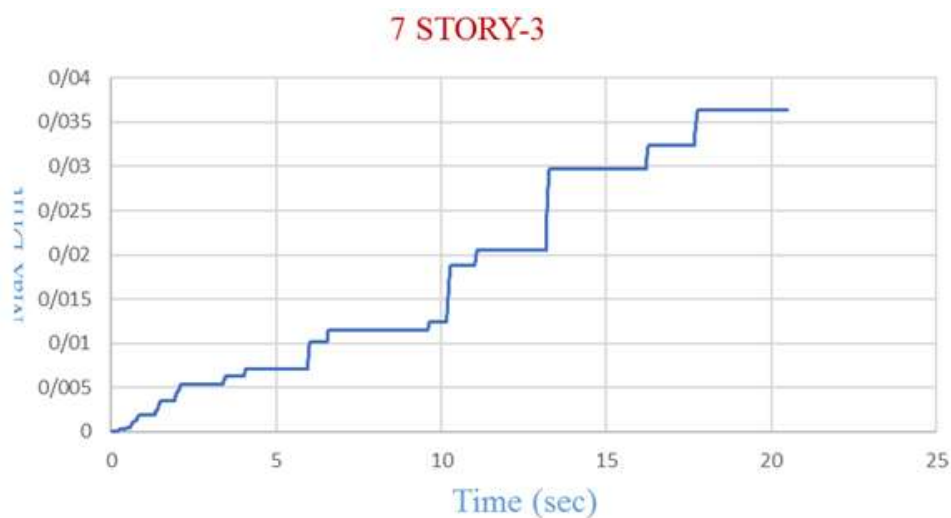
شکل ۱۳- تغییر مکان نسبی طبقات نسبت برای ساختمان ۷ طبقه مدل سوم در ثانیه های ۵، ۱۰ و ۱۵ روش زمان دوام
