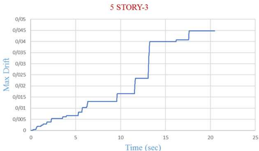
شکل ۹- تغییر مکان نسبی طبقات نسبت برای ساختمان ۵ طبقه مدل سوم در ثانیه های ۵، ۱۰ و ۱۵ روش زمان دوام
