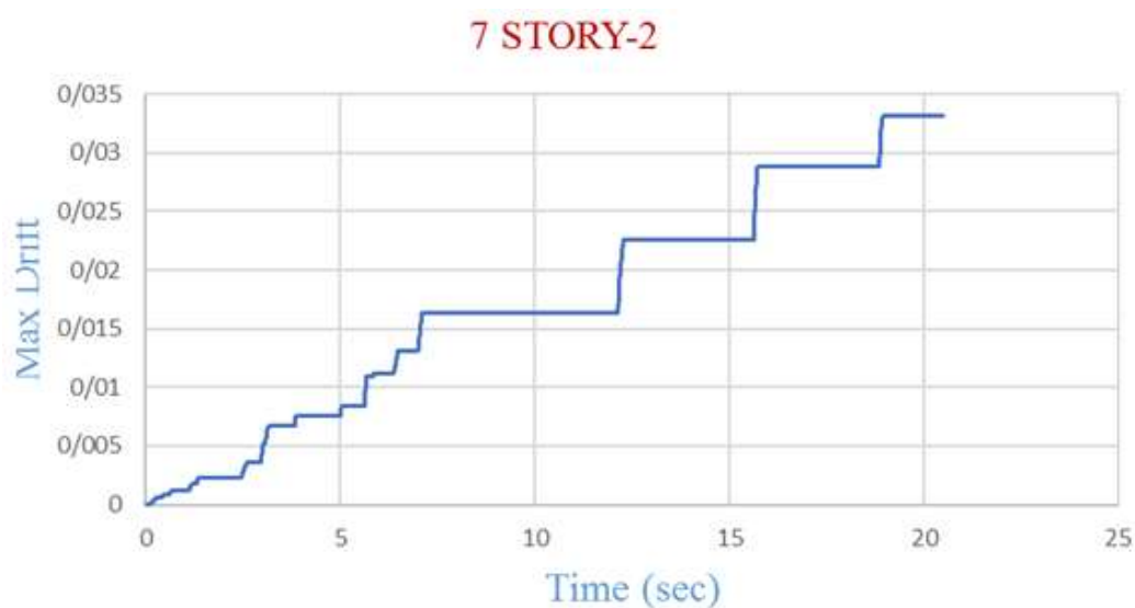
شکل ۱۲- تغییر مکان نسبی طبقات نسبت برای ساختمان ۷ طبقه مدل دوم در ثانیه های ۵، ۱۰ و ۱۵ روش زمان دوام
