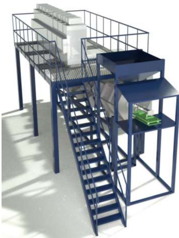
شکل ۲: ستاپ مایکروویو برای پردازش مواد اولیه معدنی فلزات کمیاب و کمیاب خاکی
