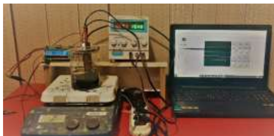
شکل ۷- راه‌اندازی سیستم پوشش دهی پالسی
