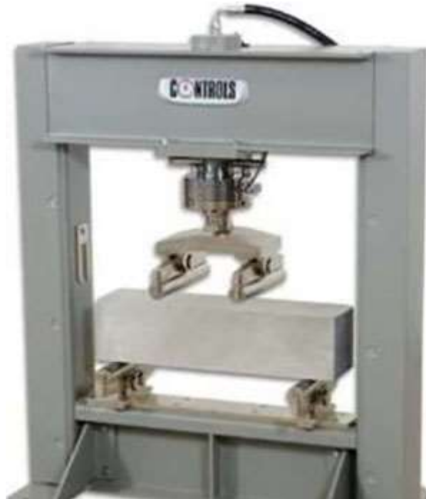
شکل ۱۵. ماشین آزمایش خمشی و نمونه ی بتنی (ASTM C78)
