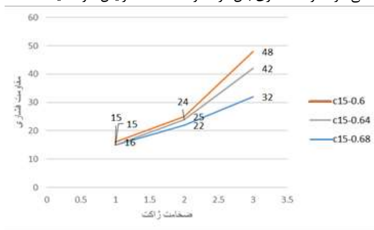
شکل ۸- نمودار قیاسی کسب مقاومت ۲۸ روزه ( f_c=15\text{mpa} ) تحت آزمایش مقاومت ۲۸ روزه فشاری- با نسبت آب سیمان w/c=0.68 , w/c=0.64 , w/c=0.60 با ضخامت ژاکت‌هایی (1cm-2cm-3cm)
