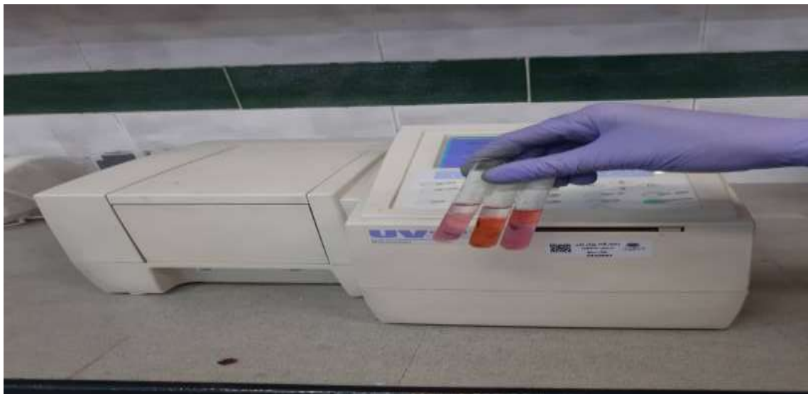
شکل ۳- اندازه گیری میزان پرولین گیاهان بنفشه ( Viola gracilis ) و گل میمونی ( Antirrhinum majus ) تحت تنش سرما با استفاده از دستگاه اسپکتروفتومتری
