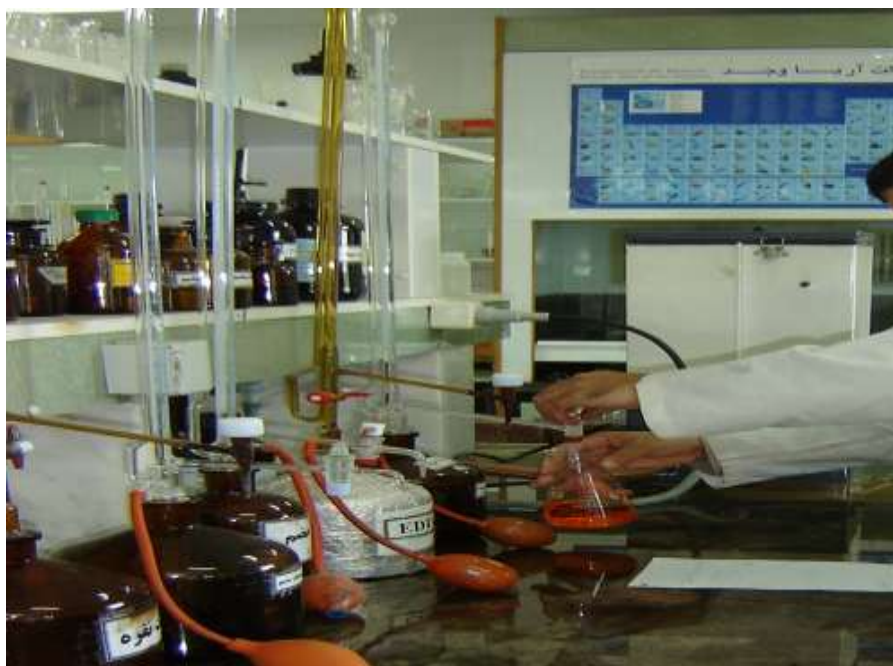
شکل ۳- اندازه‌گیری اکسیژن محلول به روش تیتراسیون (یدومتری) با محلول استاندارد تیوسولفات سدیم
