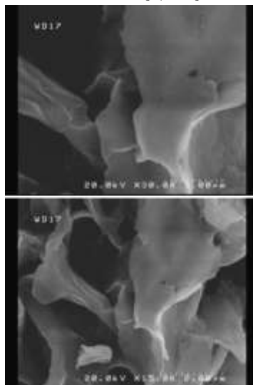
شکل ۱۳- تصاویر SEM نانوذرات روی فریت سنتز شده در دمای ۱۷۰ درجه سانتی گراد و زمان ۱۵ ساعت. بررسی خصوصیات نانوذره \text{ZnFe}_2\text{O}_4 سنتز شده به روش هیدروترمال در دمای ۱۳۰ درجه سانتی گراد و زمان ۱۵ ساعت
