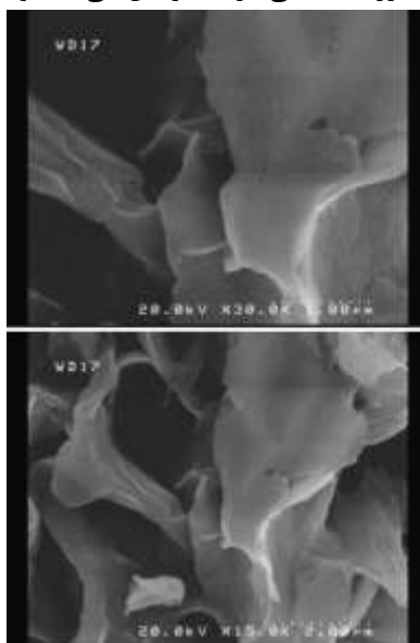
شکل ۹- تصاویر SEM نانوذرات روی فریت سنتز شده در دمای ۱۷۰ درجه سانتی گراد و زمان ۱۵ ساعت. بررسی خصوصیات نانوذره ZnFe 2 O 4 سنتز شده به روش هیدروترمال در دمای ۱۳۰ درجه سانتی گراد و زمان ۱۵ ساعت
