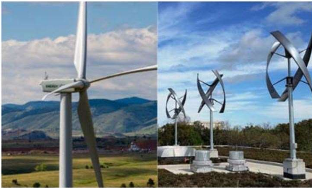
شکل ۵- دو نوع عمودی و افقی توربین های بادی [۱۱].
