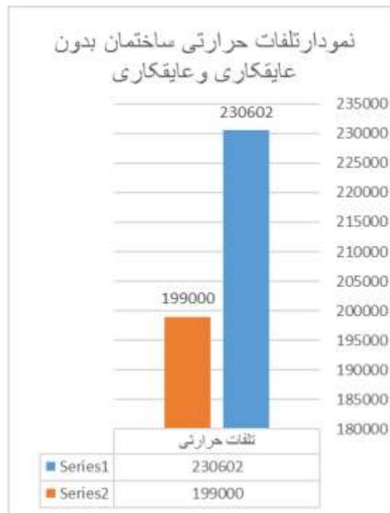
نمودار ۴: تلفات حرارتی ساختمان بدون عایقکاری و عایقکاری
