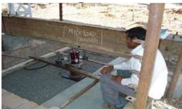
شکل ۱- محفظه و جعبه آزمایش بارگذاری صفحه
