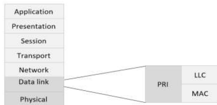
شکل ۱. PRI در مدل OSI
