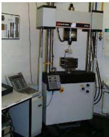
شکل ۶. دستگاه تست خستگی Instron مدل ۸۵۰۲
