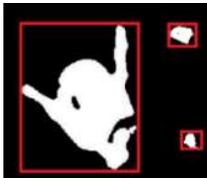
شکل ۴- محدوده پیکسل‌های متصل به هم در تصویر باینری
