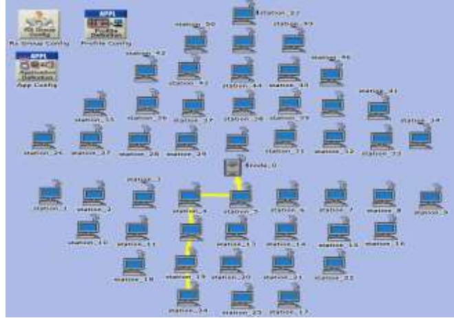
شکل ۱: نمایی از شبکه شبیه‌سازی شده برای بررسی بهترین پروتکل برای مسیریابی در شبکه MANET با ۵۰ گره
