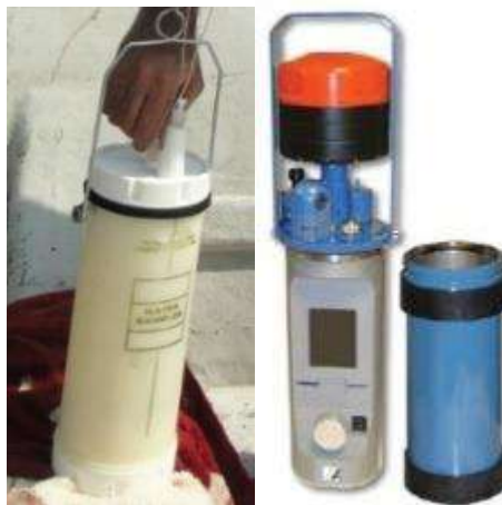
شکل شماره ۳. CTD مدل Seaguard RCM و بطری نمونه‌بردار
